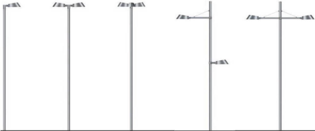
VARIANTY ULOŽENÍ SVÍTIDLA NA SLOUP, LZE VOLIT PODLE POTŘEBY, NAPŘÍKLAD NIŽŠÍ V BLÍZKOSTI NADJEZDU, ABY SVÍTIDLO NEOSLŇovalo VOZIDLA)
